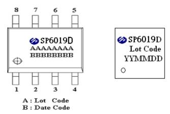
SP6019D Synchronous Rectifier Driver
